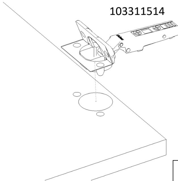
Scharniere in die Bohrung einsetzen
