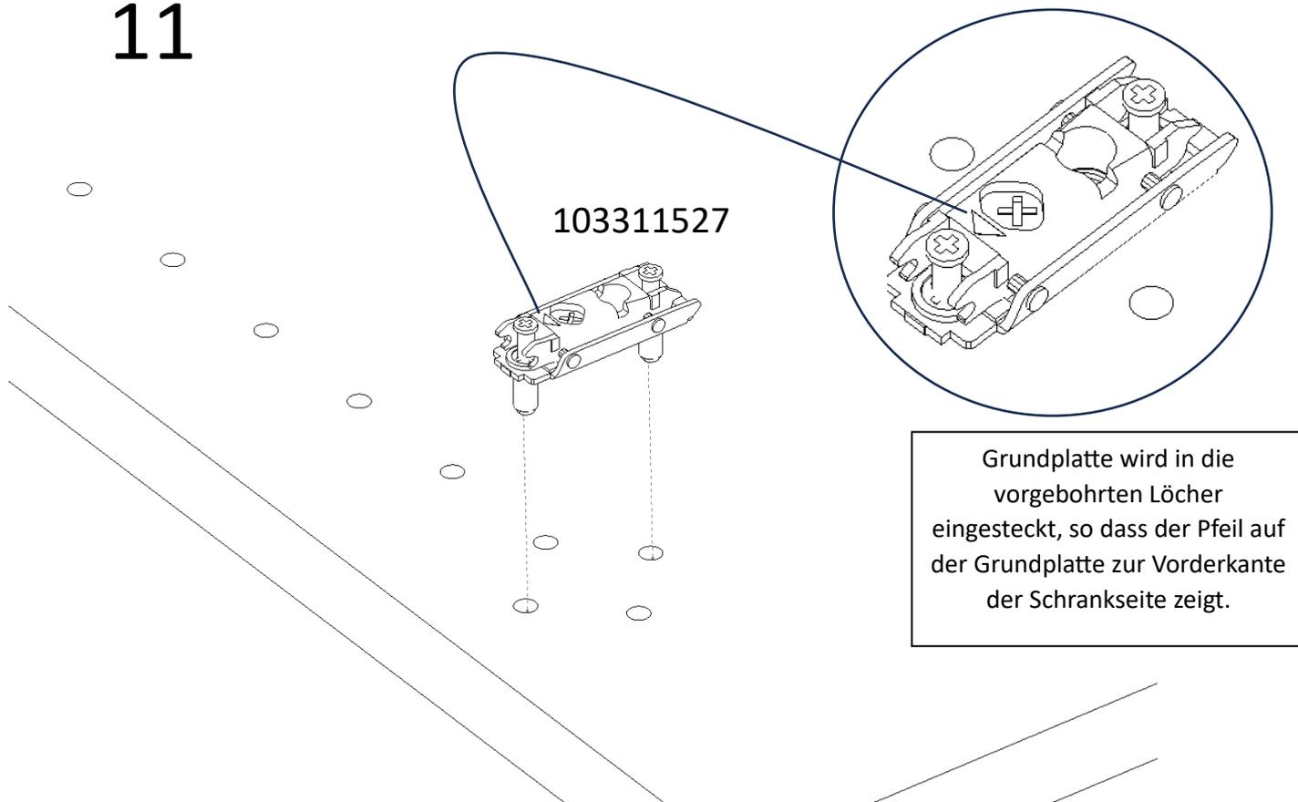
Grundplatte wird in die vorgebohrten Löcher eingesteckt, so dass der Pfeil auf der Grundplatte zur Vorderkante der Schrankseite zeigt.
