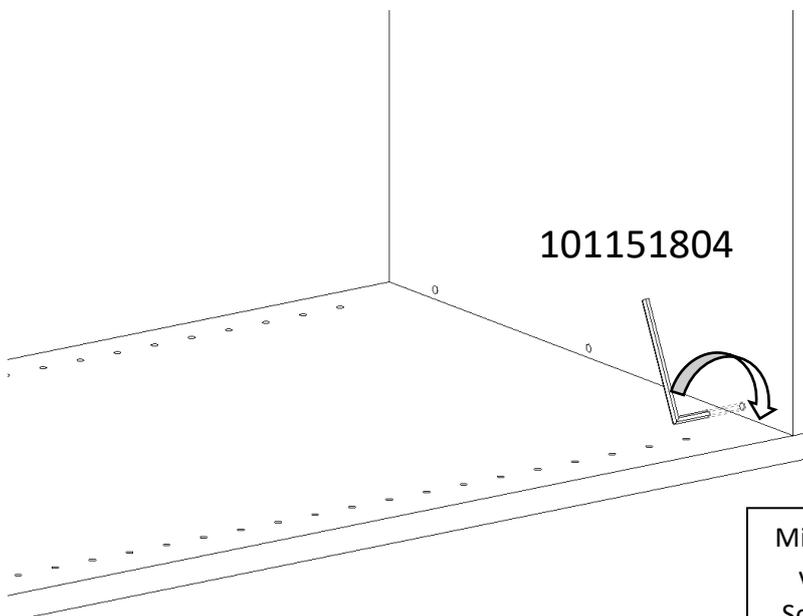
Mit den Inbusschlüssel, in den vorgebohrten Löchern der Schrankböden, die Verbindler festziehen.
