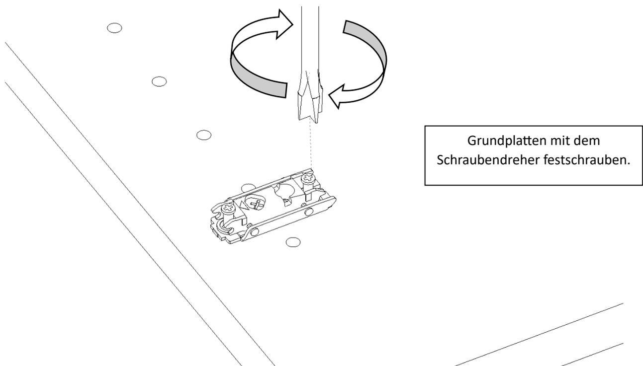
Grundplatten mit dem Schraubendreher festschrauben.
