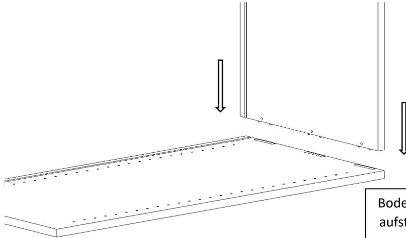
Bodenplatten auf die Schrankseiten aufstecken. Achten Sie darauf, dass die Vorderkante von der Schrankseite bündig mit der Vorderkante der Bodenplatte ist.
